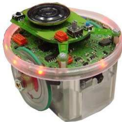
Figure 7 - Le robot e-puck. On aperçoit aisément le cercle de diodes rouges, le haut-parleur (pièce circulaire noire) et la caméra (petit élément noir à l'avant du robot, sous la diode frontale). Les capteurs infrarouges sont logés juste sous l'anneau de leds rouges.
