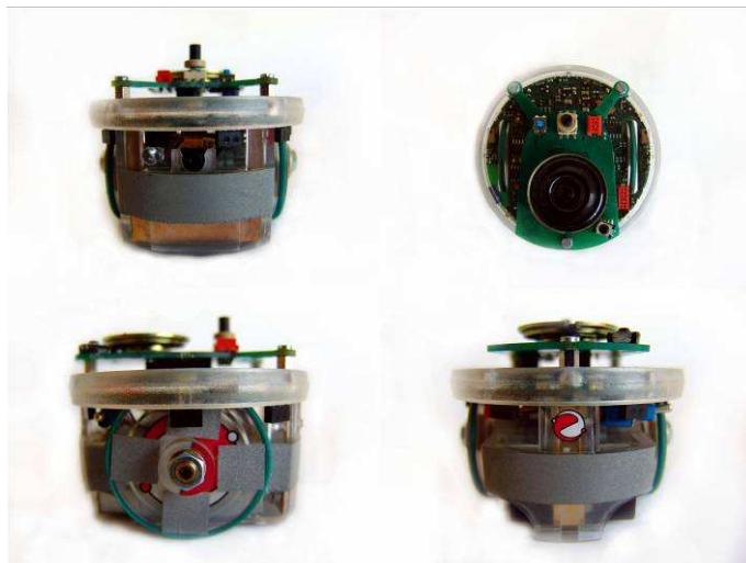
Figure 8 - Les e-pucks ont été munis de bande réfléchive afin d'améliorer et d'uniformiser leur détection mutuelle à l'aide de leurs capteurs infrarouge. Cette bande réfléchive a été placée tout autour de l'e-puck, y compris sur ses roues.
