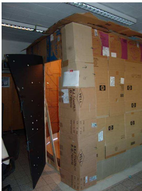
Figure 11 – Afin de s'affranchir des fluctuations de la lumière ambiante, nous avons construit un environnement contrôlé. L'arène a été entièrement construite en bois et carton.
