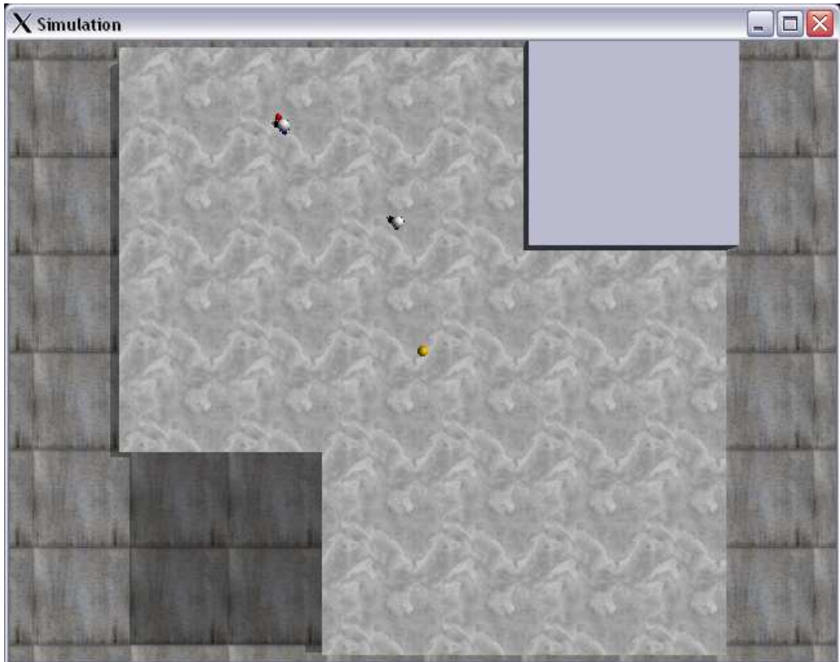
Figure 1 - TwoDee, le simulateur des S-bots. On aperçoit ici 2 S-bots et une source lumineuse (au centre). Le bloc supérieur droit est un obstacle, le bloc inférieur gauche est un trou. Des textures ont été activées afin d'obtenir un meilleur rendu visuel.
