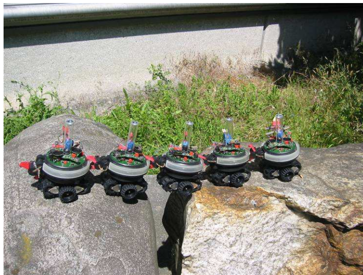
Figure 3 - Un swarm-bot est un ensemble de S-bots attachés les uns aux autres par leur pince. Cette configuration est, par exemple, utilisée pour traverser ensemble un trou qu'ils ne seraient pas parvenus à franchir individuellement.
