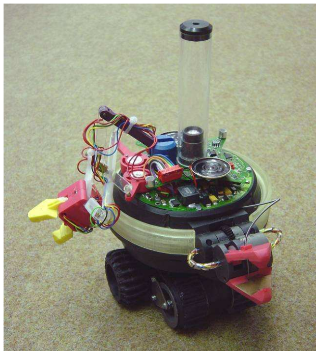
Figure 2 - Un robot S-bot. On aperçoit, entre autres, la caméra (en bas du tube transparent), la pince, le bras amovible et les chenilles du robot.
