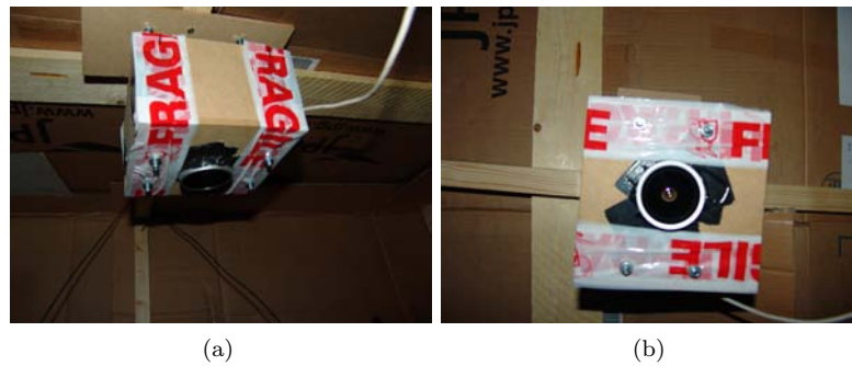
FIG. 4.2 – (a) photo du boîtier contenant la webcam. La méthode de fixation qui a été utilisée pour le boîtier (boulons et écrous) permet de régler aisément la hauteur de la webcam. (b) Vue de la lentille grand angle placée devant la caméra afin d’avoir une vision de l’arène dans son entièreté.
