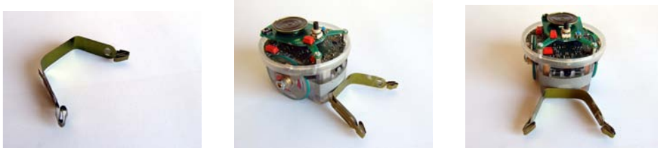
FIG. 3.4 – La pince du robot e-puck sous différents angles. Sa structure est très simple et sa mise en place se fait aisément avec du papier collant.
