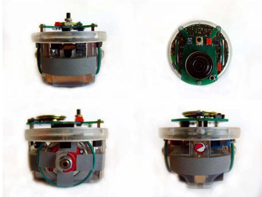
FIG. 3.22 – Configuration finale de l'habillage du robot fournissant une détection suffisante.
