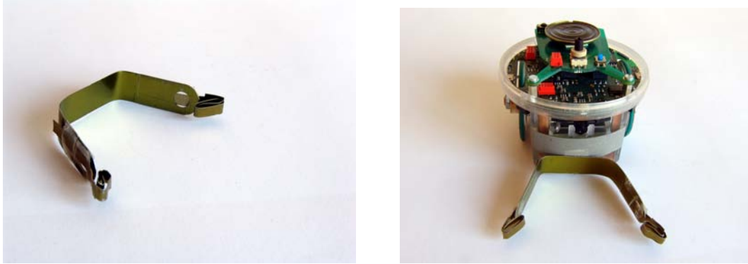
FIG. 3.4 – Sur ces photographies, vous pouvez observer la pince que nous avons ajoutée, afin de pouvoir déplacer des petits objets à l’aide des robots.
