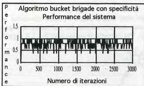
Fig.5.8 - Performance del sistema usando l'algoritmo bucket brigade con specificità (SBB): Forza media: 0.8 Deviazione standard: 0.17
