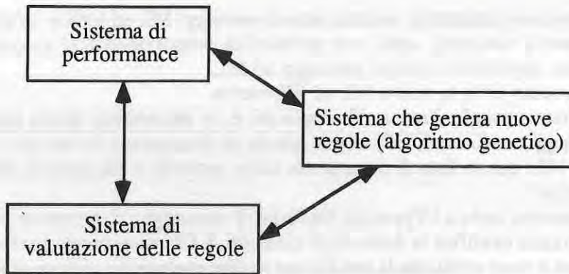
Fig.5.28 - Struttura di un SC classico
