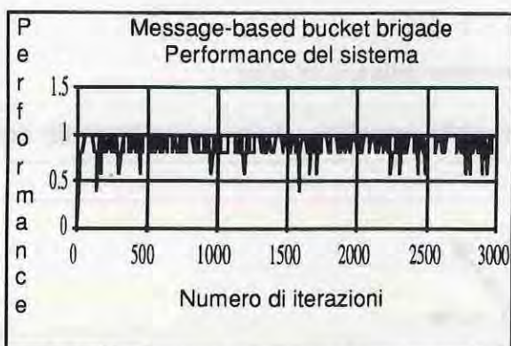
Fig.5.10 - Performance del sistema usando l'algoritmo message-based bucket brigade (MBB): Forza media: 0.91 Deviazione standard: 0.12
